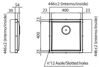
**Schema di fissaggio** | Disegni in sezione per il fissaggio secondo lo spessore di 12mm o di 20 mm
